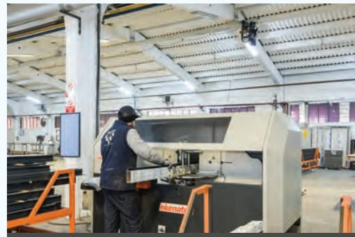
PROFİL KERTME / NOTCHING MACHINE / MACHINE À ENCOCHER
